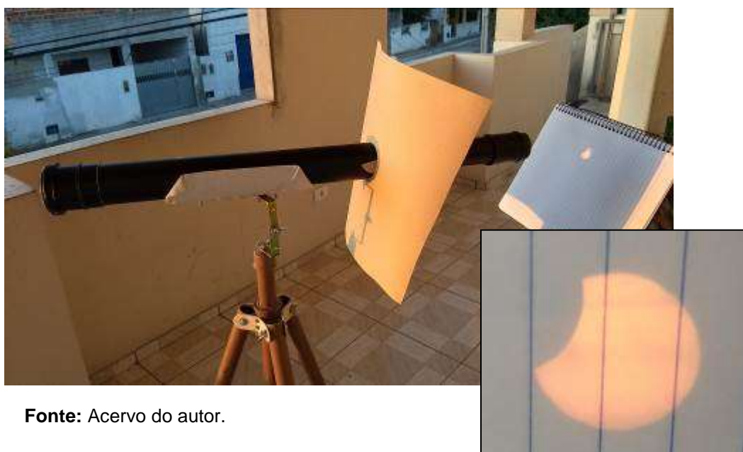
Figura 24 – Sessão de registro e transmissão do Eclipse Solar com telescópio refrator caseiro.
